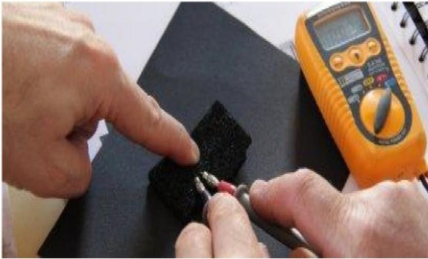
Capteur de pression, matériau mousse anti-statique
